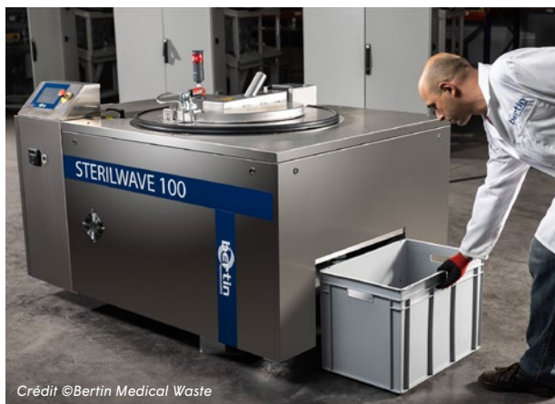
Procédé de banalisation DASRI avec la technologie micro-onde.
